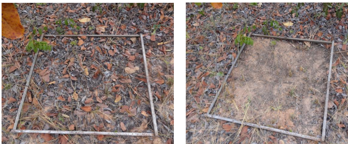
Figura 15: Procedimentos utilizados em campo para determinação da biomassa de serrapilheira na fitofisionomias estudadas em Jaborandi, BA.
