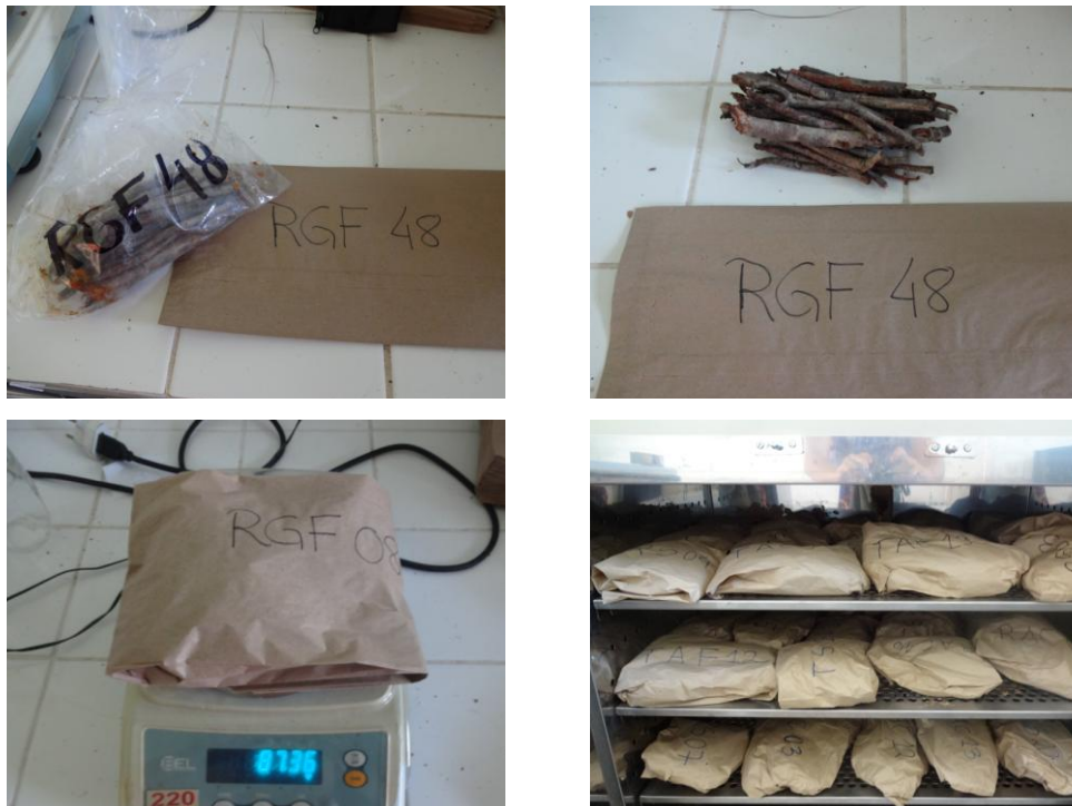
Figura 16: Procedimentos realizados em laboratório para determinação do peso de matéria seca das amostras coletadas em campo.
