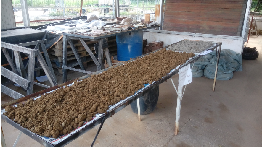
Figura B.9: Amostras de solo secando ao ar.
