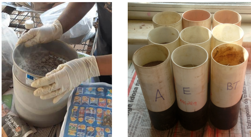
Figura B.10: Amostras peneiradas e acomodadas em recipientes de PVC.
