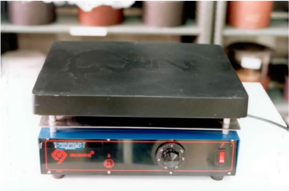
FIGURA 5. Placa aquecedora (38 cm de comprimento x 30 cm de largura) utilizada para o aquecimento do sangue contido nas placas de vidro.
