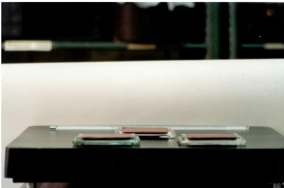
FIGURA 4. Placas de vidro (7 cm de largura x 9 cm de comprimento com capacidade para 16 ml de sangue) utilizadas na alimentação artificial através de membrana de silicone.
